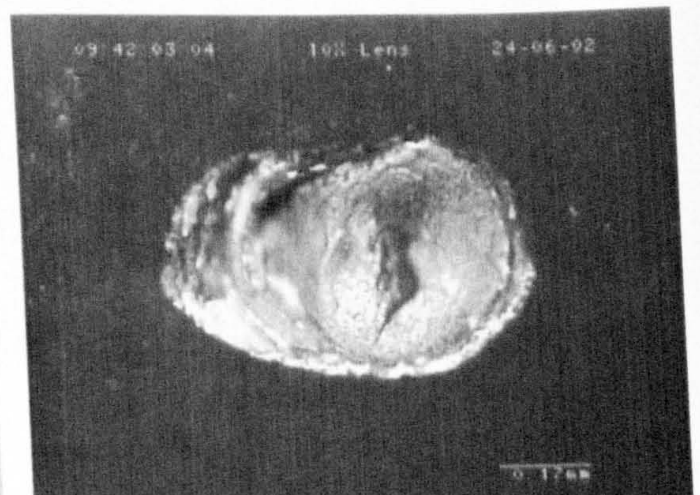
(d) Overview of the spall (dark field)
